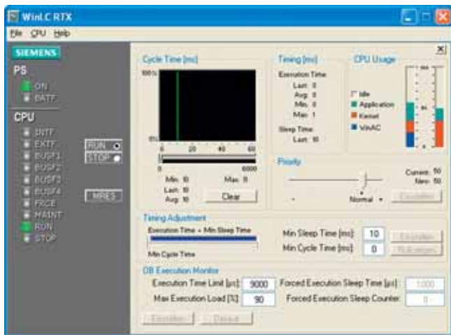
SIMATIC WinAC RTX のオペレータインターフェース
